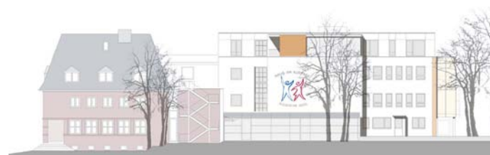
Um ein Staffelgeschoss mit verglastem Aufenthaltsraum und Balkonanlage wird der zum Kurpark weisende Gebäudeteil erweitert, der einen weiten Blick über den Park ermöglicht.
